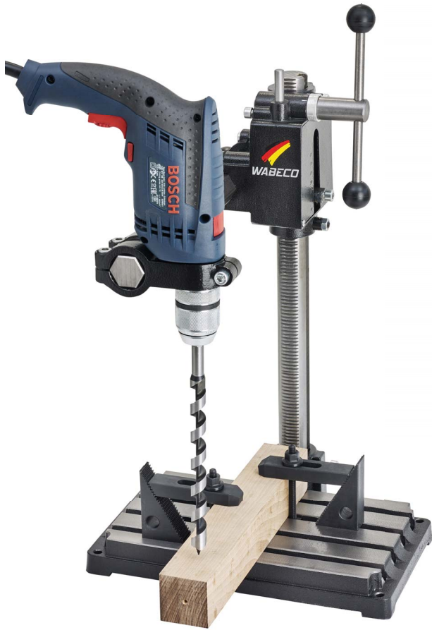
Bohren mit Schlangenbohrer
