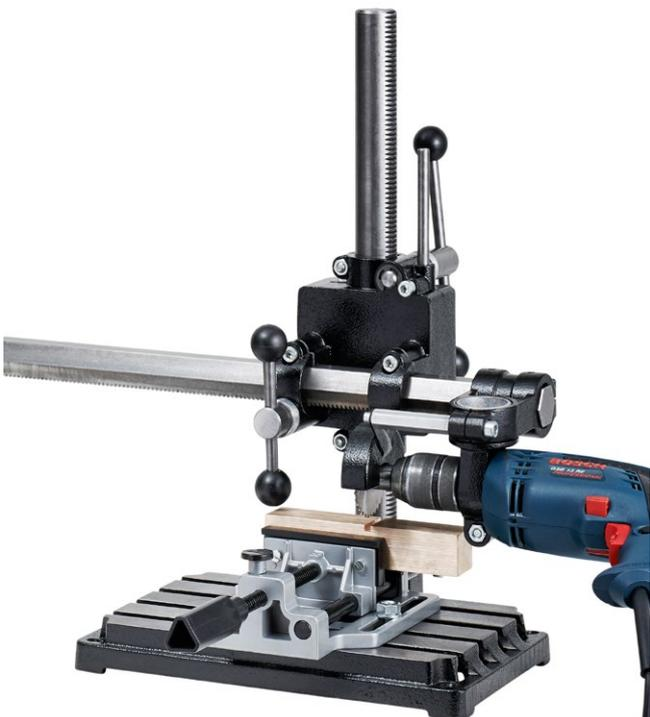
Nut mit Sägeblatt fräsen
