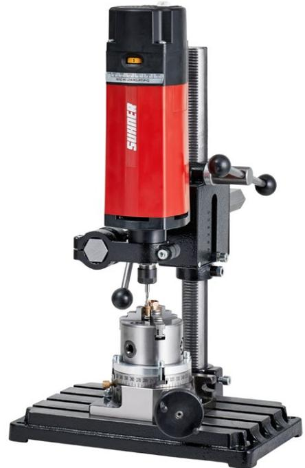
Vertikales Fräsen mit Teilapparat
