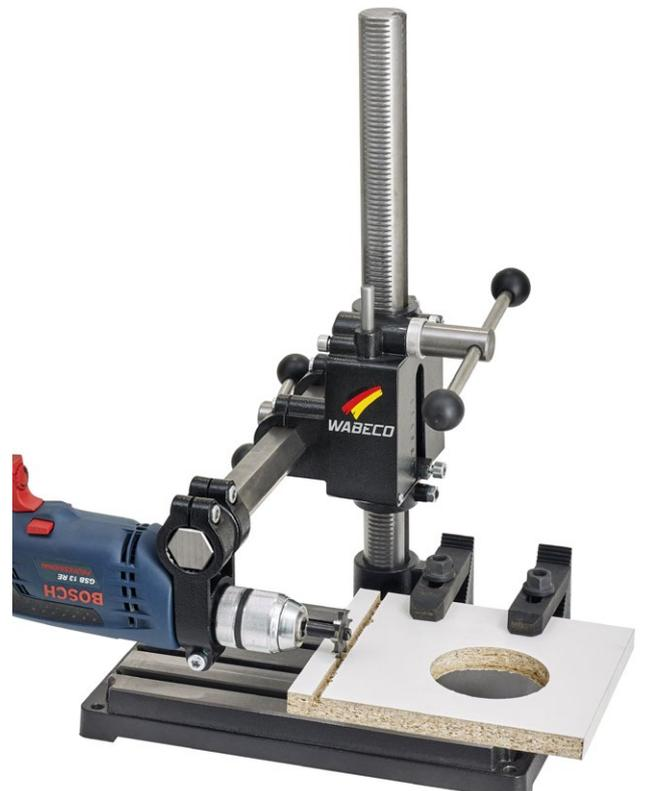
Fräsen mit Schlitzfräser
