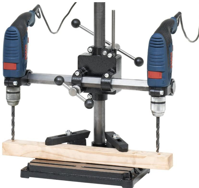
Bohren mit 2 Antriebseinheiten
