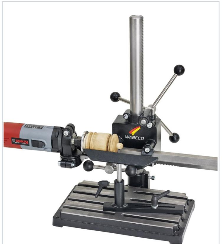
Längsdrechseln mit Planscheibe
