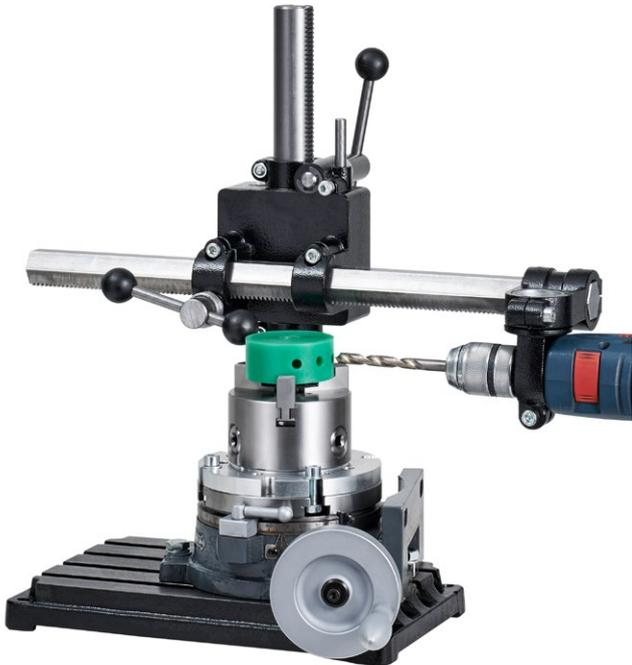
Horizontales Bohren mit Teilapparat
