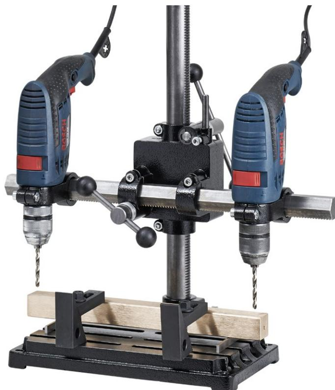
Bohren mit 2 Antriebseinheiten
