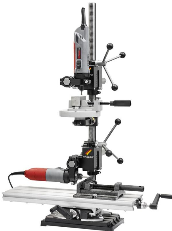
Arbeiten mit 2 Führungseinheiten
