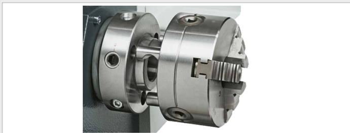
**Camlock Schnellverschluss an der Hauptspindel**
