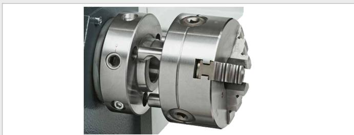
Camlock Schnellverschluss an der Hauptspindel
