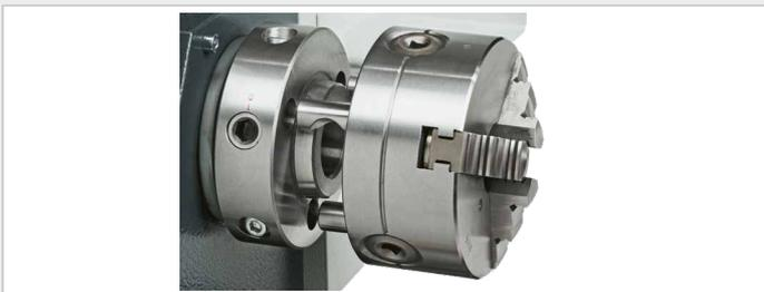
Camlock Schnellverschluss an der Hauptspindel
